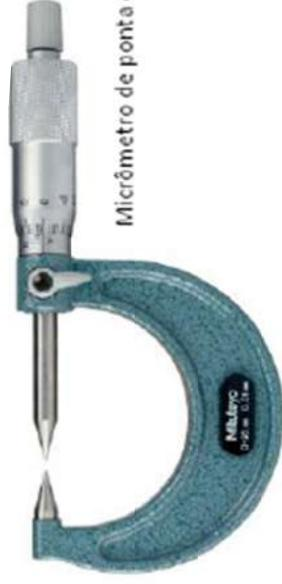
Micrômetro de ponta cônica.
