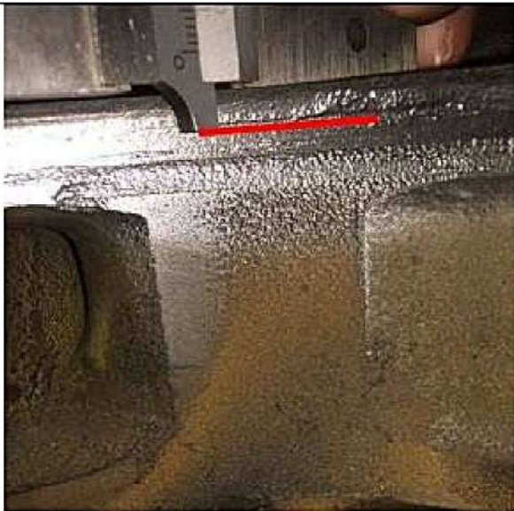
Região medida com 5,0mm a partir da superfície do bloco
