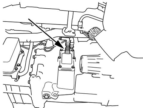
O sensor de velocidade de rotação localiza-se na tampa da roda da marcha à ré
