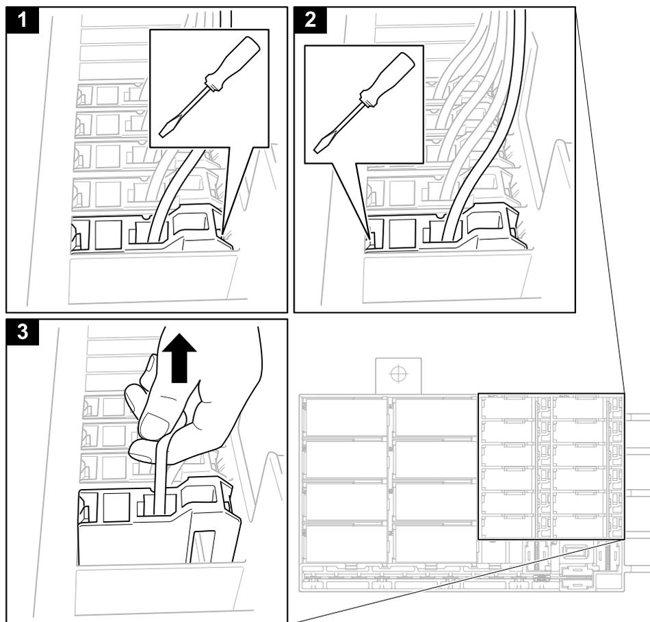
3. Remova todos os suportes do relé. Instale os suportes de relé na mesma posição na nova unidade elétrica central.
