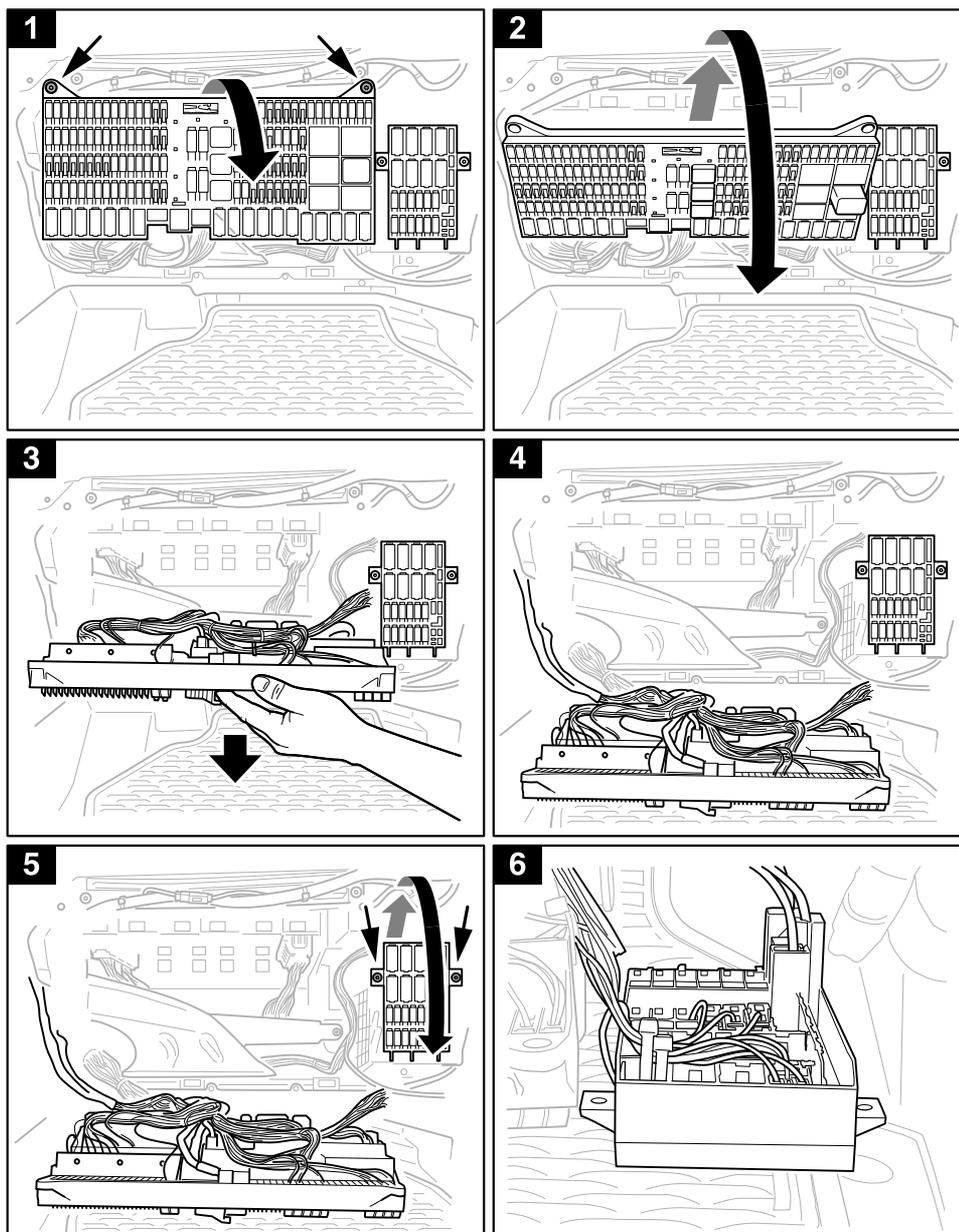
2. Remova todos os porta-fusíveis. Instale o porta-fusíveis na mesma posição na nova unidade elétrica central.
