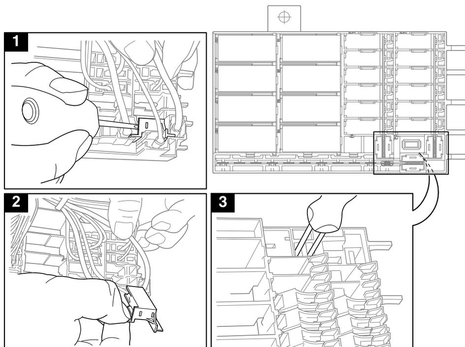
5. Fixe o chicote de cabos à nova unidade elétrica central com todas as presilhas de cabo. Coloque a unidade elétrica central nos suportes, dobre-a e coloque os parafusos na borda superior.
