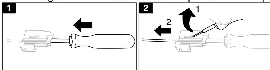
1. Instale a ferramenta de remoção no porta-fusível.
