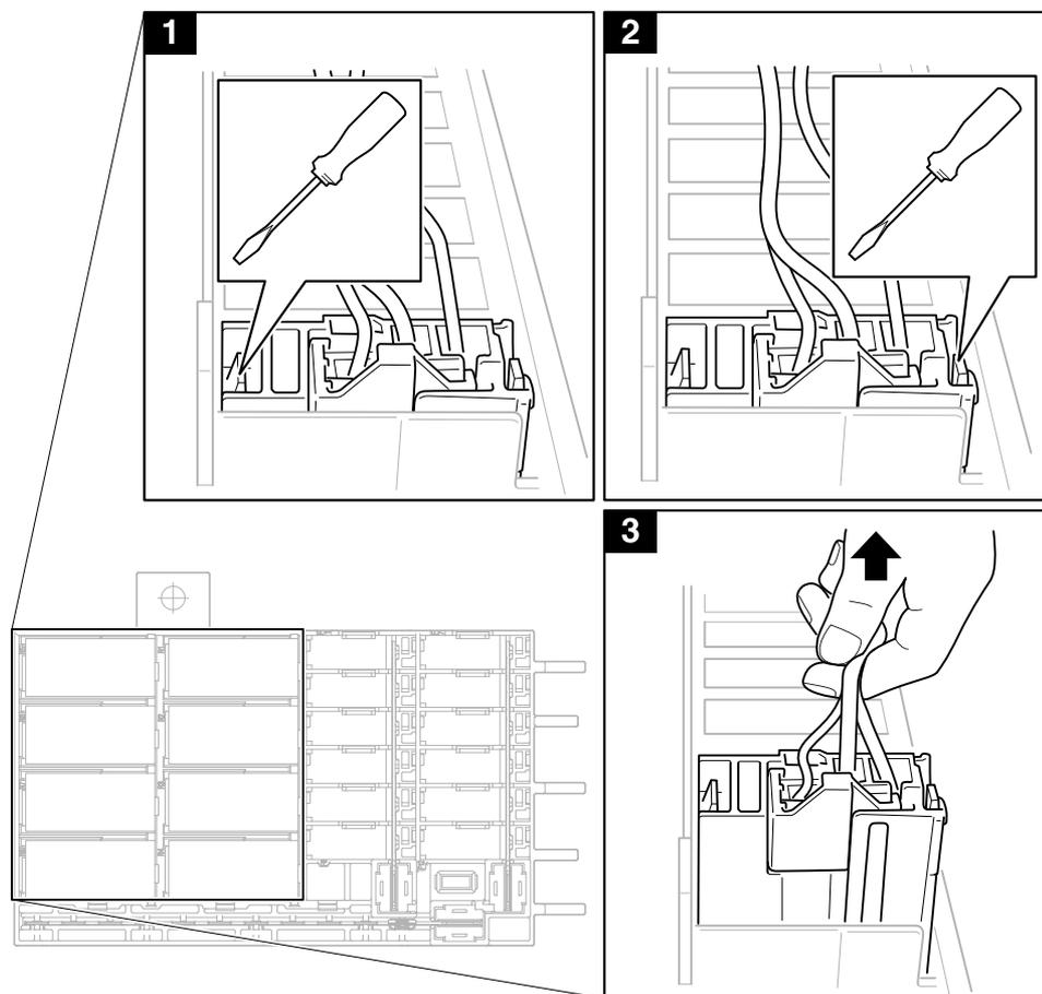
4. Remova a trava secundária e desprenda os terminais de cabo utilizando a ferramenta
