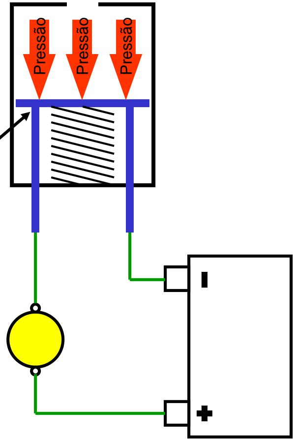
*Exemplo de aplicação: Filtro de óleo obstruído (Bypass)*
