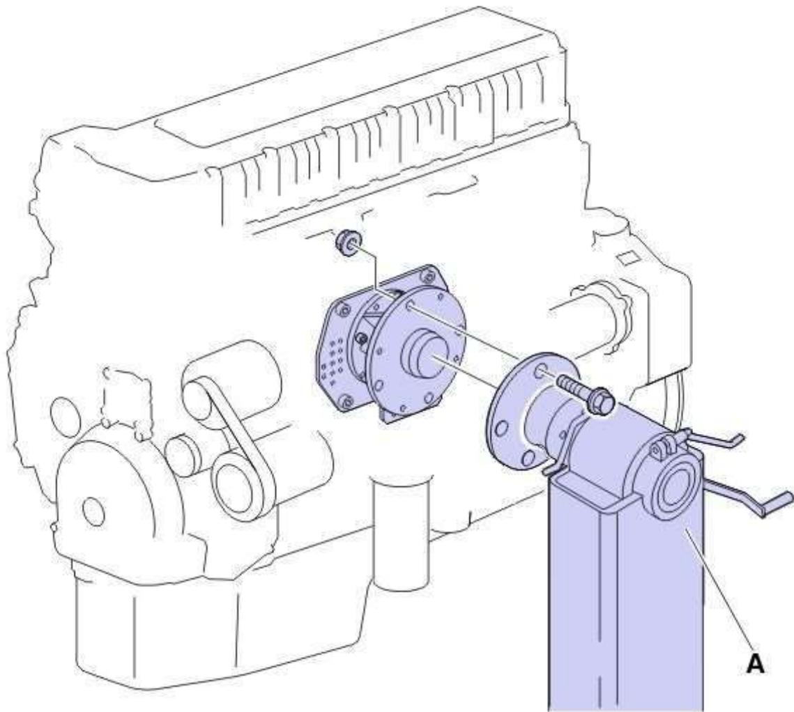
Remova o equipamento de levantamento do motor.
