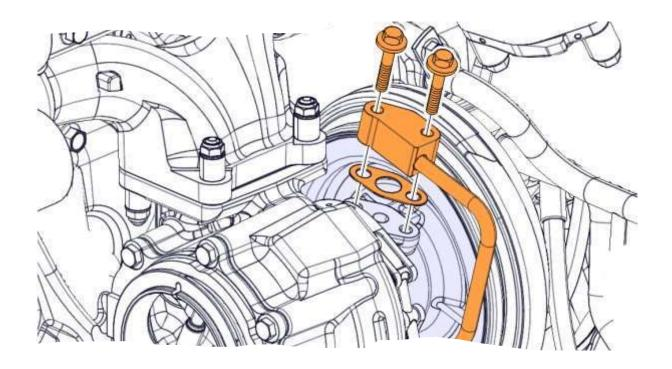
Aplicar o torque nos parafusos.
