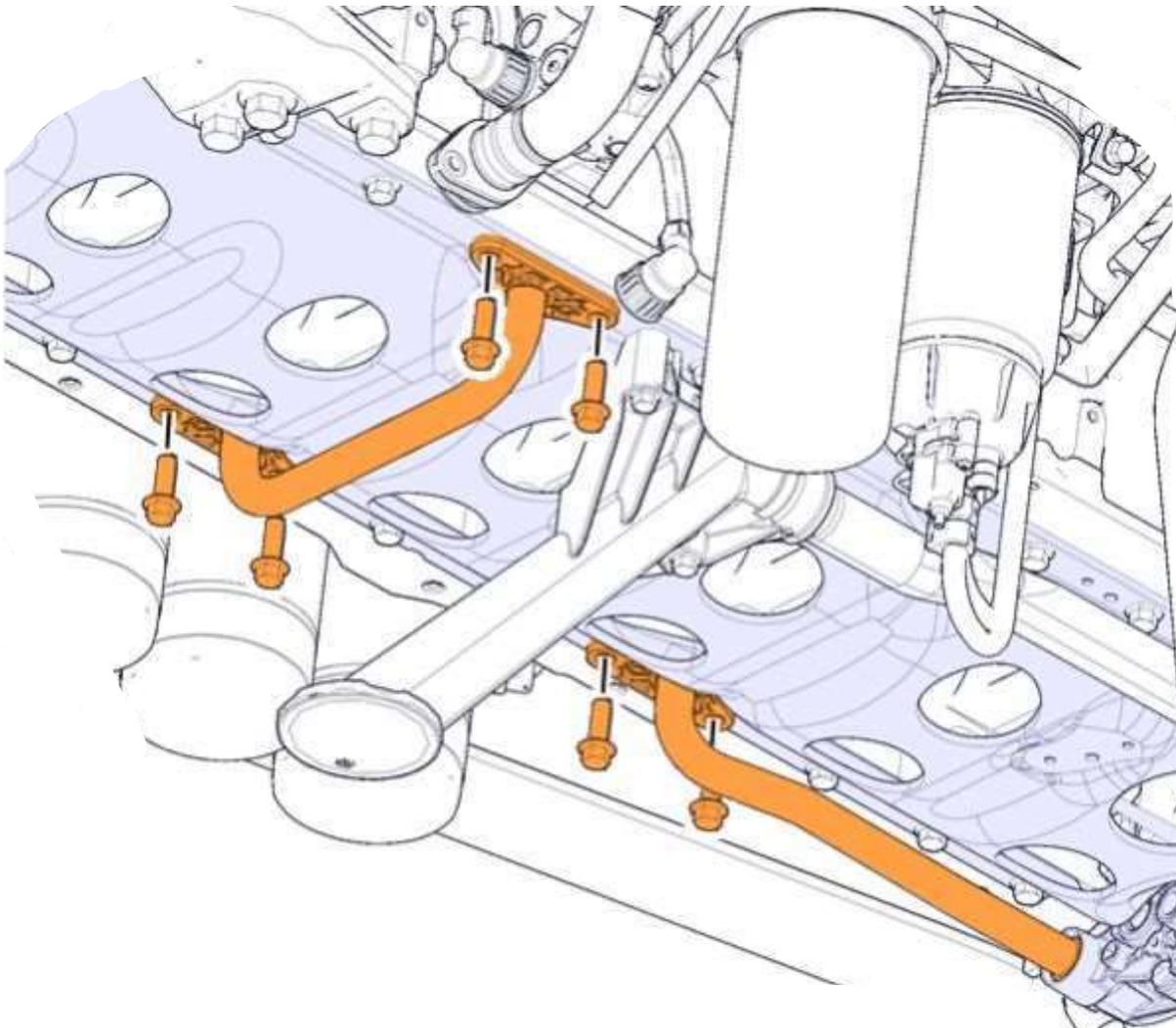
Aperte os parafusos com o torque adequado.
