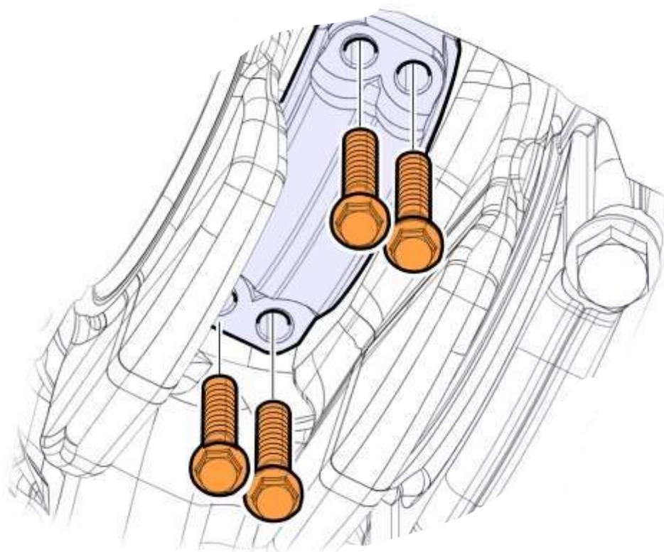
27 | Anerte os parafusos com o torque adequado.
