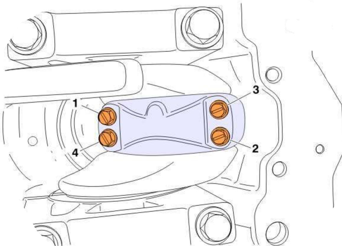
Girar o volante do motor com a ferramenta de acionamento da partida de forma que o próximo par de capas esteja acessível.
