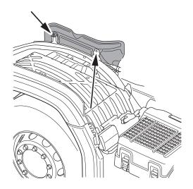
**6.** Se elas foram removidas, instale a parte superior dos para-lamas em ambos os lados do veículo.
