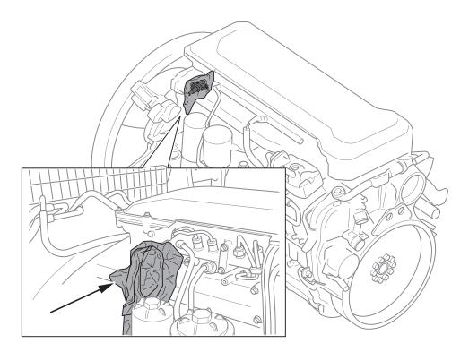
**4.** Remova as sujeiras grossas do motor usando, por exemplo, uma escova, escova de aço ou um raspador.
