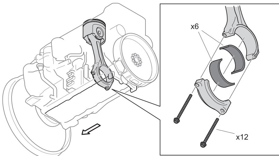
**9.** Levante o pistão e a biela até que o anel de pistão atinja a superfície superior do bloco de cilindros e se expanda de modo que o pistão e a biela repousem suspensos no anel de pistão. Coloque fita adesiva em torno da pista do mancal e do duto de óleo na árvore de manivelas com o lado adesivo voltado para fora para proteger os dutos de óleo.
