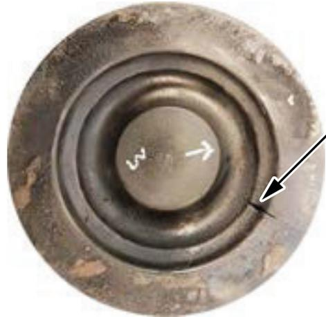
Pistão com formação de trincas devido a superaquecimento.
