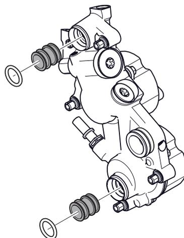
2. Remova o anel de vedação-O do lado de baixo do bloco distribuidor de combustível.
