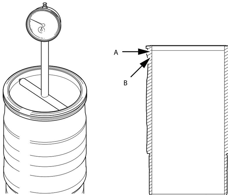
2. A diferença entre a reentrância de desgaste do cilindro (A) e o orifício do cilindro (B) pode ser, no máximo, 0,06 mm.
