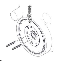
**4.** Instale *3 006 136 Ferramenta de bloqueio* para o volante e aperte os parafusos do volante.
