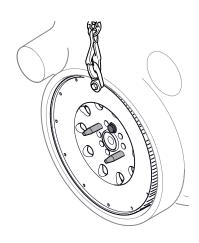
**3.** Excluir *3 006 033 Pinos-guia* e instale os parafusos restantes com *2 789 884 Tomada de 24 mm, 12 faces* e aperte-os com a mão. Use parafusos novos.
