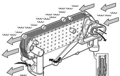
Esquema estrutural dos fluxos de água e óleo para radiadores de óleo nos motores de 9, 11, 12 e 13 litros
