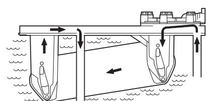
Esquema estrutural dos fluxos de água e óleo para radiadores de óleo nos motores de 16 litros
