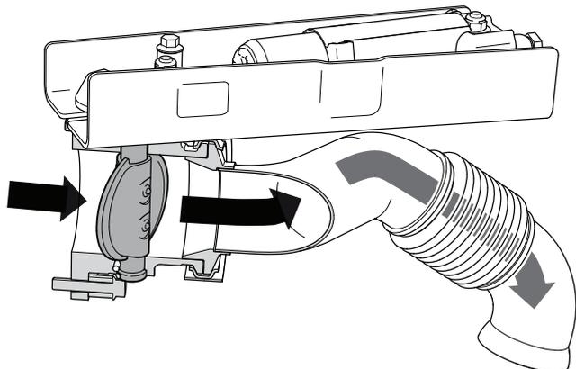
Visão geral - Válvula da EGR, motores de 13 litros
