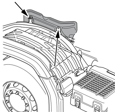
6. Instale a parte superior e o para-lama dianteiro no lado esquerdo do veículo.
