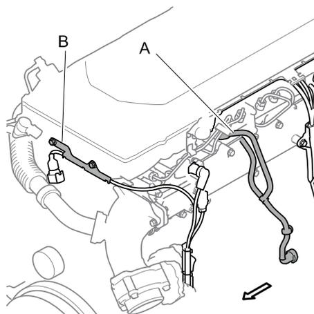
8. Instale o conector de chicote-a-componente e as novas presilhas de cabos do chicote de cabos do injetor.
