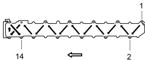
Sequência de aperto, motores de 13 litros com geração de bloco de cilindros 3
