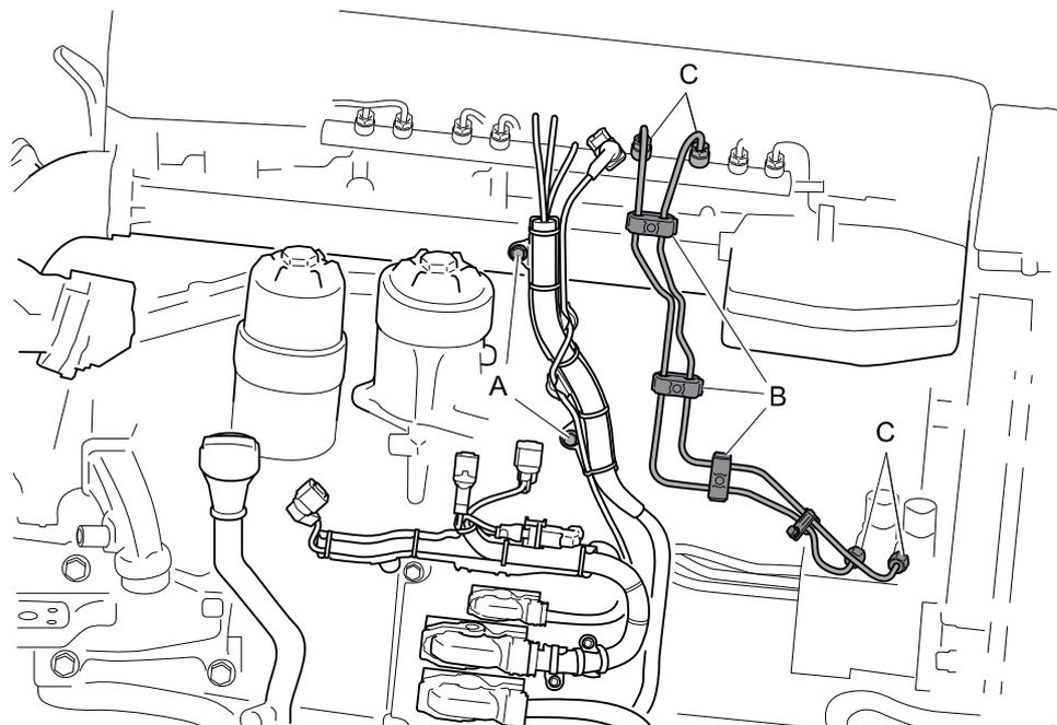
7. Instale os tubos de retorno de combustível e o duto para chicotes no sensor de pressão dos gases de escape.
