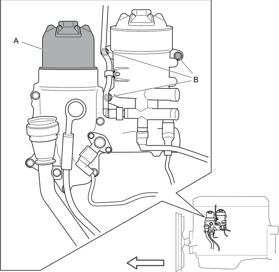
3. Remova os cabos de conexão do sensor do coletor de admissão e do sensor de pressão dos gases de escape. Coloque de lado o chicote de cabos do quadro do eixo de comando.
