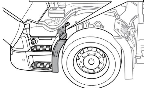
5. Remova a proteção acústica esquerda do motor.
