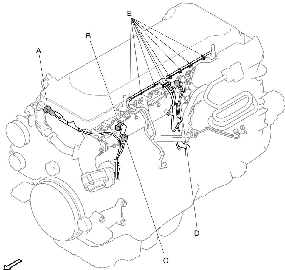
4. Desprenda os tubos de retorno de combustível do acumulador e coloque-os de lado. Desprenda o duto para chicotes do sensor de pressão dos gases de escape e afaste.
