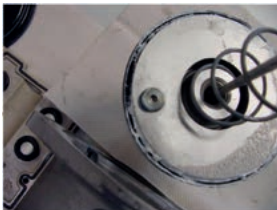
Válvula de segurança (dispositivo de restrição com válvula de retenção) Válvula de segurança: Aberta de 0 – 1.9 bar
