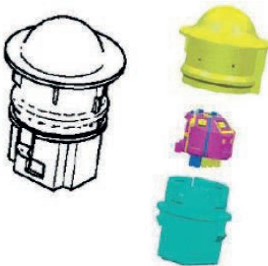
A imagem do sensor solar duplo e suas partes estão representados na figura acima. O sensor solar é considerado duplo pelo fato de possuir dois elementos sensíveis a radiação solar. Um desses elementos está direcionado para o lado do passageiro, conseguindo identificar a radiação vinda deste lado. Já o outro elemento sensor está voltado para o lado do motorista, identificando a radiação solar incidente do lado do motorista.
