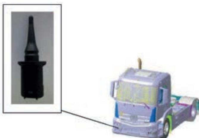
Esse sensor é um sensor do tipo NTC (coeficiente de temperatura negativo) e possui um conector de dois pinos, onde um dos pinos está conectado ao negativo e o outro pino é a conexão com a tensão de referência que é alterada de acordo com a temperatura.
