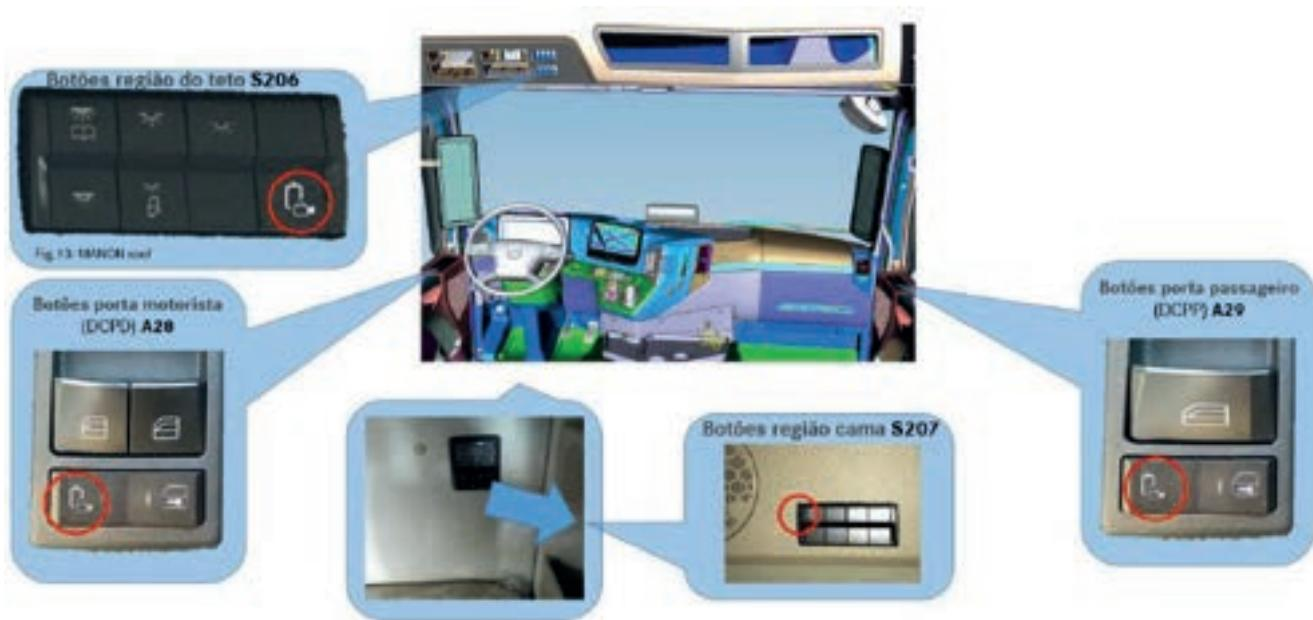
Os botões mostrados acima, para acionamento manual do sistema, não estão interligados por nenhum tipo de comunicação com as câmeras, os interruptores possuem conexão cabeadada direta para as câmeras, não é ativado nenhuma comunicação CAN.
