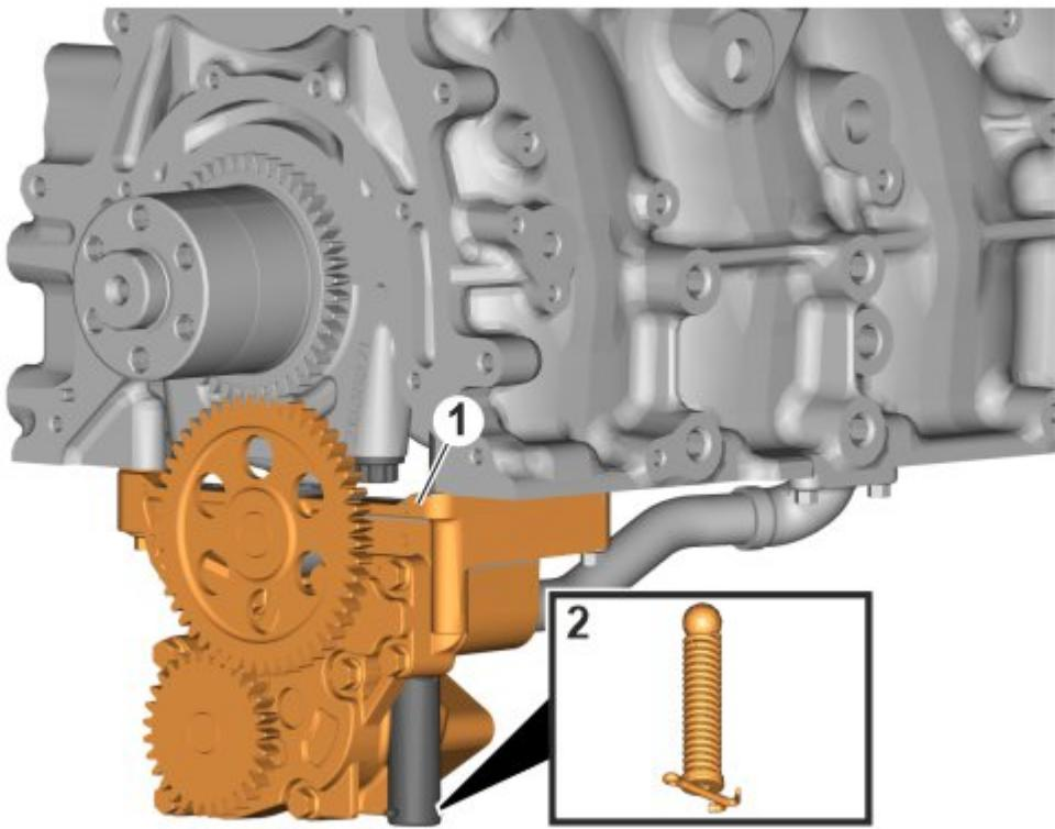
A bomba de óleo (1) é um tipo de engrenagem instalada na extremidade dianteira do motor e presa ao bloco de cilindros. A engrenagem localizada na parte dianteira da árvore de manivelas aciona a bomba de óleo. Uma válvula de segurança (2) instalada dentro da bomba de óleo controla a pressão máxima do óleo.
