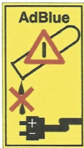
Ao manusear a solução de AdBlue é importante que os conectores elétricos estejam conectados ou também protegidos. Se não, há um risco do Adblue causar oxidação que não pode ser removida. Água ou ar comprimido não ajudam, já que o Adblue oxida rapidamente o metal.
