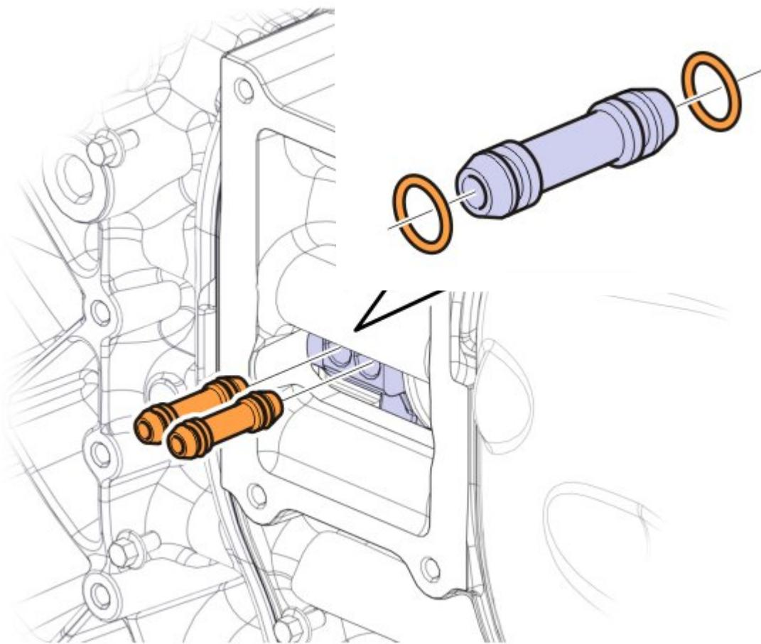
**15** Desengatar a marcha reduzida soprando ar no furo ou usando uma ferramenta.
