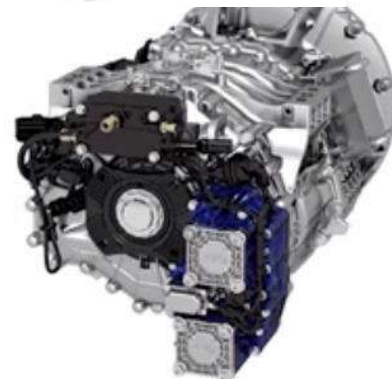
4 VARIANTES: PTO DUPLA DE VELOCIDADE MULTIPLICADA
