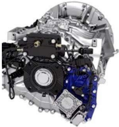
1 VARIANTE: PTO SIMPLES ACCIONAMENTO DIRECTO
