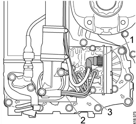
2. Remova o bloco de válvulas solenoide e anéis de vedação-O (3 x).
