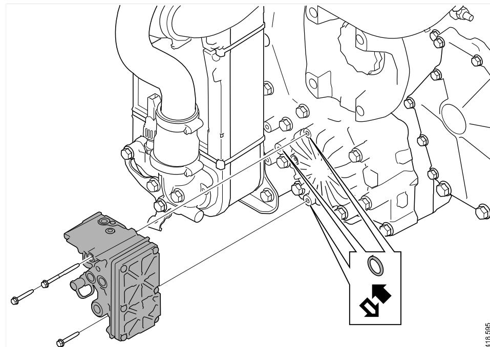
3. Instale três novos anéis de vedação-O e o bloco de válvulas solenoide.
