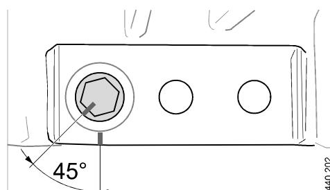
Remova o suporte de motor. Reinstale os parafusos do cárter óleo onde estavam montados os suportes do motor. Consulte 01-20 *Sistema de lubrificação > Cárter de óleo.* 06/03/2023 (22.50.0.0) [Multi\_Authorized\_Manager] © Scania CV
