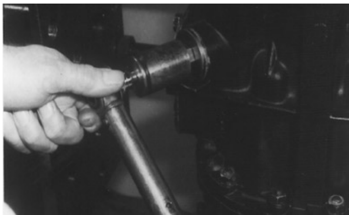
46. Aperte o filtro com torque correto.
