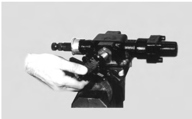
11. Aplique veda rosca e instale o respiro. Instale a válvula de acionamento utilizando uma nova junta de vedação. Posicione a válvula com as duas tomadas de saída voltadas para o lado esquerdo da carcaça e aperte os parafusos com torque apropriado.
