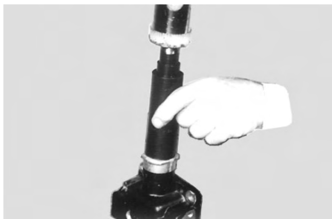
2- Substitua o vedador de óleo. Utilize a ferramenta especial E 109-5
