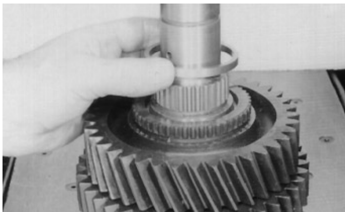
16. Instale o espaçador do rolamento na engrenagem e sobre o rolamento.
