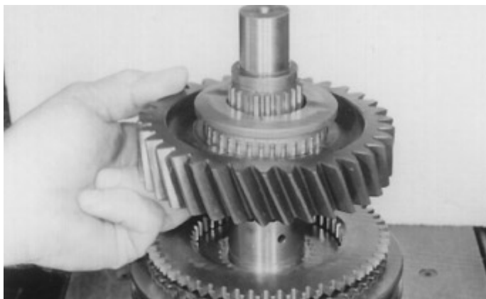
22. Lubrifique a engrenagem e rolamento da 2a marcha e posicione a engrenagem no anel sincronizador e o rolamento sobre a engrenagem.
