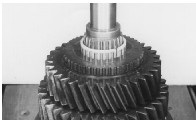
27. Lubrifique a engrenagem e rolamento da 3a marcha e posicione a engrenagem e o rolamento de 3a sobre o eixo.
