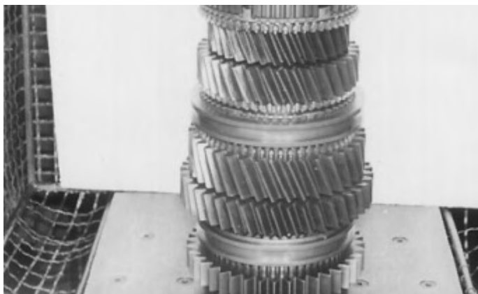
30. Tome o cubo sincronizador de 3a/4a aquecido e posicione-o, com o lado mais profundo voltado para baixo sobre o eixo. Certifique-se de que as fendas do cubo estejam alinhados como os rebordos do anel sincronizador. Pressione o cubo firmemente até sua posição e mantenha pressionado por 3 a 5 minutos.
