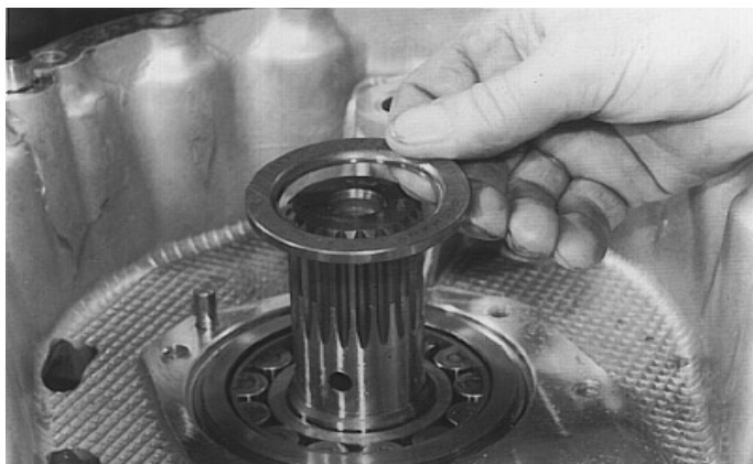
24. Remova a arruela de encosto do rolamento do eixo principal e inverta o conjunto da transmissão no suporte. NOTA: Caso o rolamento seja de esfera, a arruela de encosto não poderá ser removida neste momento.
