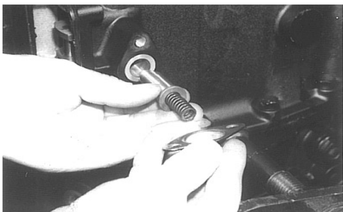
26. Remova a tampa da mola de retenção, a mola e o êmbolo ou desatarraxe o retentor da carcaça. Alguns modelos possuem uma válvula de inibição de redução alta/baixa na tampa do retentor.
