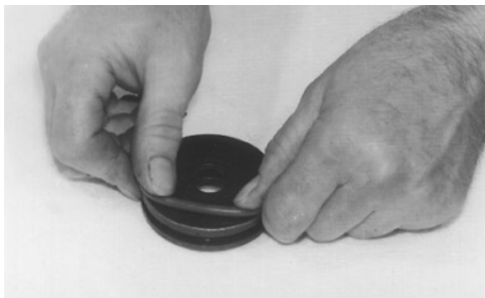
47. Aplique lubrificante de silicone e instale novos anéis de vedação do pistão de seleção, no alojamento do varão de seleção Alta/baixa, bem como em seu perímetro externo.
