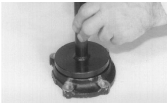
24. Instale um novo vedador de óleo no suporte utilizando a ferramenta E 109-12.
