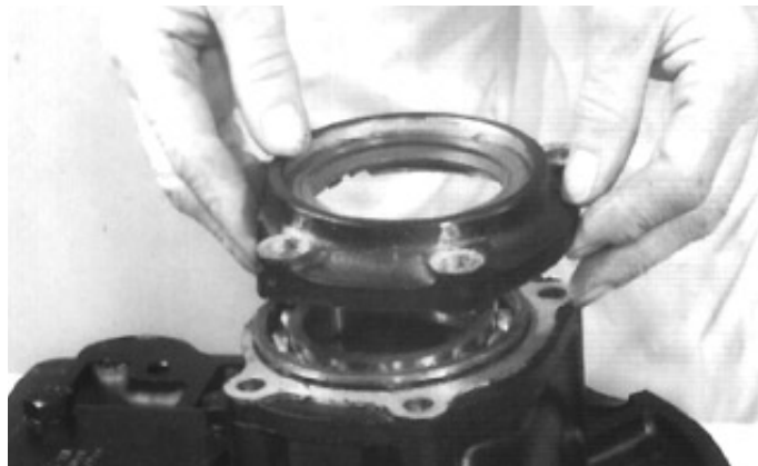
16. Remova os 4 parafusos que fixam o suporte do vedador de óleo e a carcaça do rolamento do eixo de saída. Remova o suporte do vedador de óleo.
