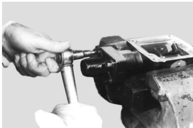
8. Aplique veda rosca aos parafusos e aperte com torque correto (20 to 24 Nm).
