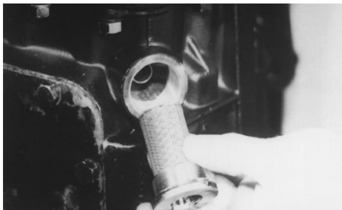
45. Instale o filtro na carcaça da transmissão, utilizando uma nova arruela.
