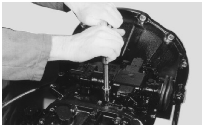
12. Aplique vedante na flange e instale o controle remoto. Certifique-se de que a alavanca interna esteja sobre o bloco seletor. Instale e aperte os parafusos com torque apropriado.
