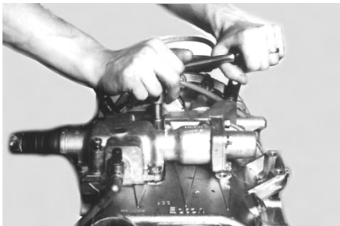
1-Remova o conjunto do controle remoto da transmissão.
