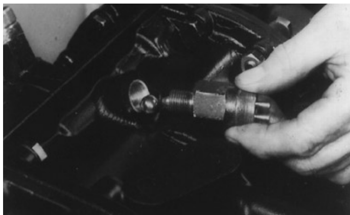
58. Instale o interruptor e a esfera de neutro na transmissão. Aperte com torque correto.
