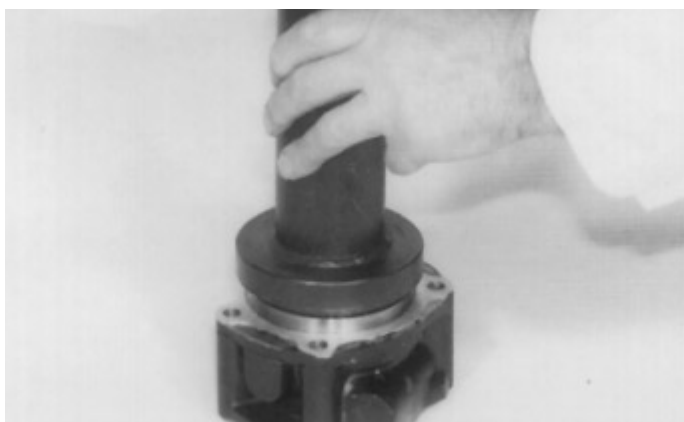
23. Instale o rolamento do eixo de saída na carcaça utilizando um martelo de borracha e uma ferramenta apropriada.
