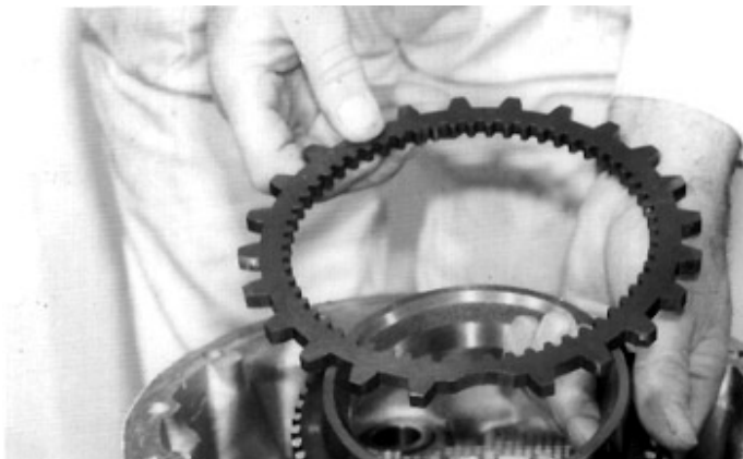
13. Retire a placa de reação e a flange de sincronização de ré (baixa)
