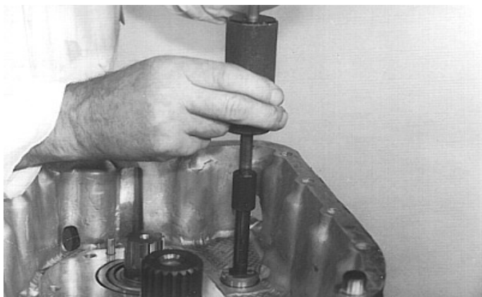
22. Rosqueie o martelete deslizante MS 284 na parte traseira do eixo da engrenagem louca de ré e retire o eixo da carcaça. Remova o pino do eixo.
