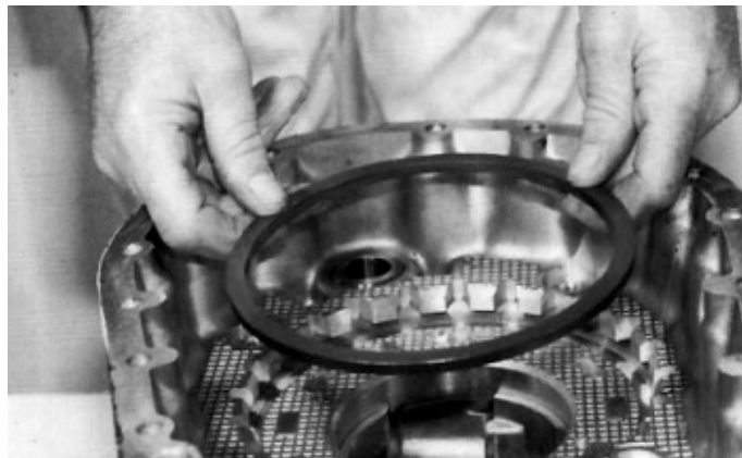
14. Retire o espaçador. Em alguns modelos pode haver um vedador de óleo adicional na parte traseira da carcaça.
