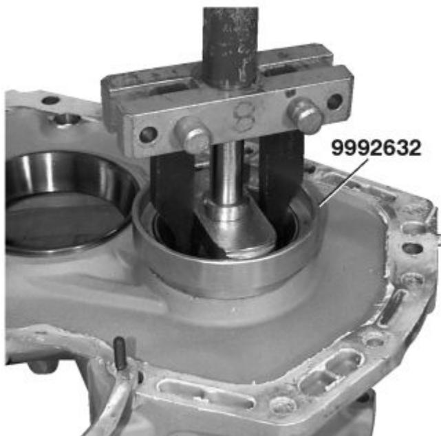
Remova a pista externa do rolamento do eixo intermediário da carcaça da embreagem. Se a pista exterior não soltar, gire o impulsionador 9992632 e extraia os restos.
