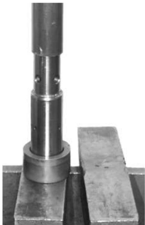
Colocar uma **nova** arruela-trava no espaçador do eixo de acionamento da bomba. Prensar o eixo no espaçador.
