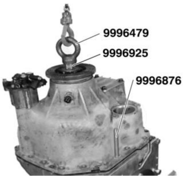
Insira os pinos na carcaça da base da caixa de mudanças. Monte 9996479 e 9996925 no eixo de saída da unidade de extensão. Posicione a carcaça de extensão sobre a carcaça da base da caixa de mudanças. Abaixe e alinhe a haste do pistão e a engrenagem planetária. Prender a carcaça da extensão. Aperte com o torque de  $75\pm10$  Nm. Certifique-se de que os três pinos de localização estejam localizados na carcaça da base da caixa de mudanças e na carcaça de extensão.
