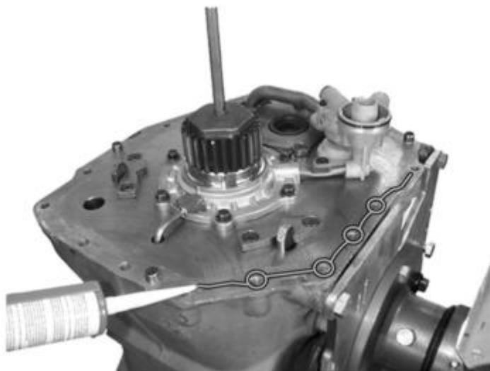
Coloque uma camada de selante, número 3092340, na superfície de contato da carcaça da base da caixa de mudanças. Consulte [Agentes de vedação \(para motores, transmissões, sistemas de arrefecimento, escotilhas, aberturas e tampas\)](#).
