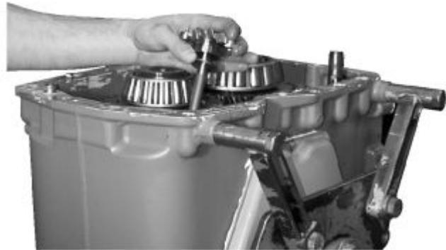
Remover o eixo motor da bomba de óleo e a arruela.
