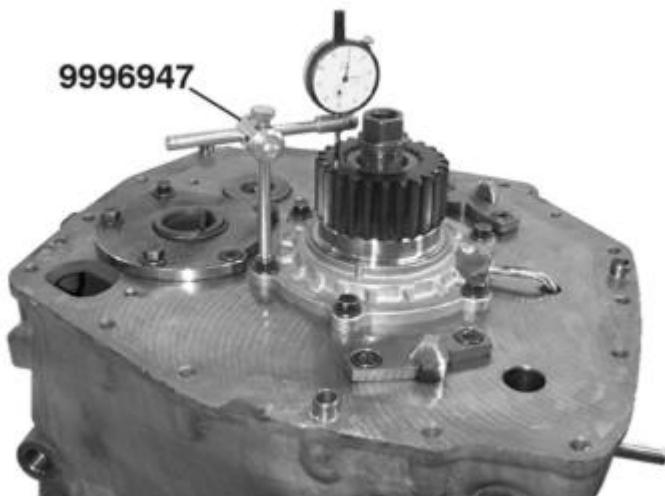
Fixe um medidor no 9996947. Substitua o pino de fixação do suporte por um parafuso (M10x150 mm) e uma porca. Fixe o parafuso em um dos orifícios de parafuso da tampa. A ponta do medidor deve estar em contato com a roda solar. Zere o medidor e marque o ponto de medição.
