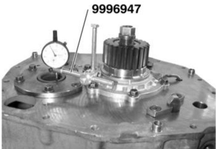
Transferir o relógio comparador para o eixo intermediário. Zerar o relógio e marcar o ponto de medição.
