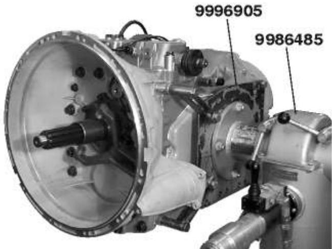
Fixar o dispositivo de fixação na caixa de mudanças. Instalar a caixa de mudanças no cavalete de recondicionamento.
