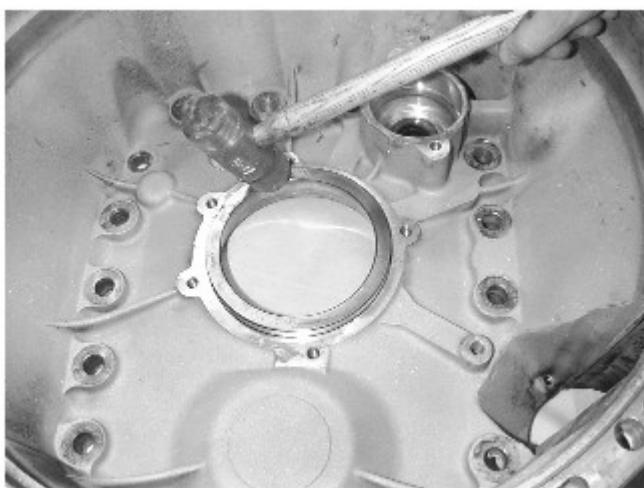
Bater cuidadosamente a pista externa do rolamento do eixo principal para dentro da carcaça da embreagem para que a mesma se fixe perfeitamente. Em seguida, prensar a pista externa até a borda da superfície da carcaça da embreagem.
