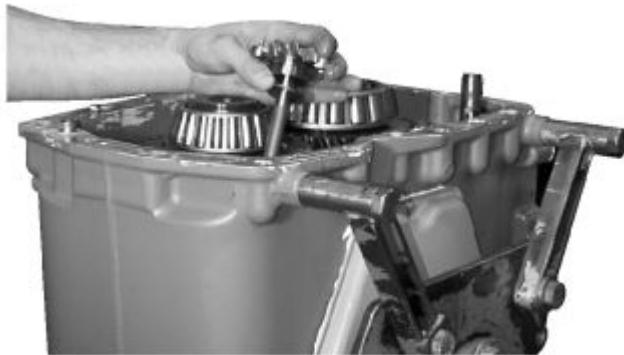
Inverter a posição da caixa de mudanças. Remover a ferramenta de elevação e seus pinos guia. Instalar o eixo de acionamento da bomba com a arruela de encosto e empurrar o eixo através da arruela-trava com um mandril de bronze e um martelo de plástico. Certificar-se de que o eixo de acionamento está fixo levantando a engrenagem.
