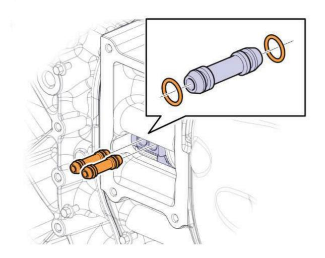
31 Desengatar a marcha reduzida soprando ar no furo ou usando uma ferramenta.
