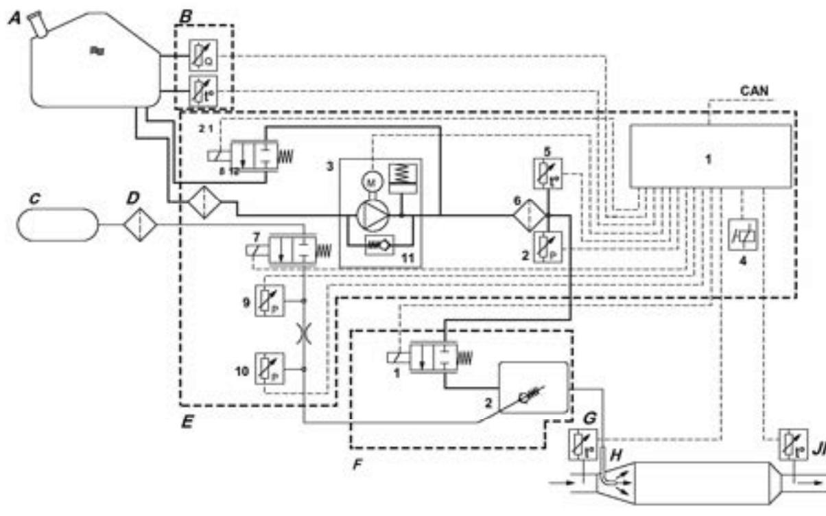
Dependendo da velocidade do motor, o binário do motor e da temperatura dos gases de escape é injectada uma certa quantidade de AdBlue. A quantidade de AdBlue é controlada através do controlo da válvula de medição (E) que possui um determinado ciclo de trabalho. A pressão na unidade de AdBlue EAS é mantido constante; a pressão de ar é dependente da dose na quantidade de AdBlue.
