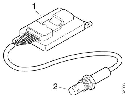
O sensor consiste em um módulo do sensor de eletrônico (1) com um cabo que leva ao sensor (2). As peças não podem ser separadas.
