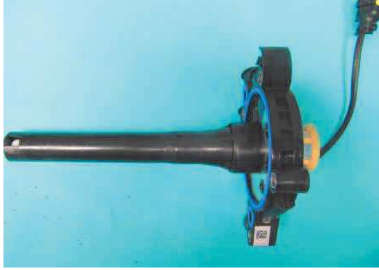
Aquecedor do combustível
