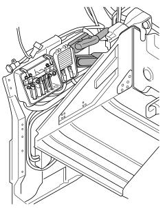
**6.** Solte as conexões ao chicote de cabos sob os fusíveis e arranque-as do parafuso para que fiquem livremente suspensas.
