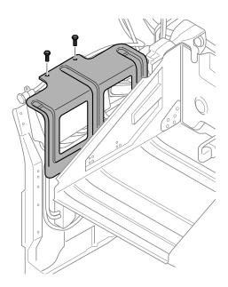
**3.** Remova a tampa à unidade elétrica central do chassi do fusível que vai verificar ou substituir.
