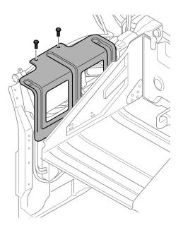
7. Remova o para-lama. A unidade elétrica central do chassi é suspensa na mesma placa que o para-lama.
