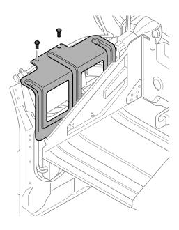
**4.** Remova a tampa da unidade elétrica central do chassi a ser substituída.
