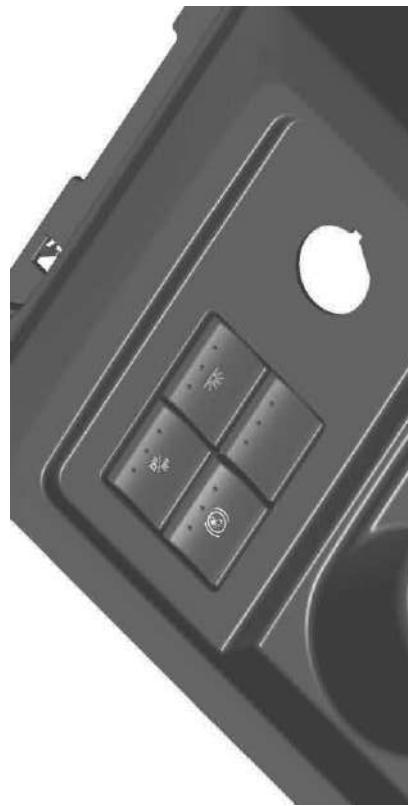
Ao pressionar o botão de acionamento do Sistema Auxiliar de Partida em Rampas posicionado no Console Central, com o veículo parado, sem falhas e com o freio de estacionamento desacionado a espia indicativa se acende.
