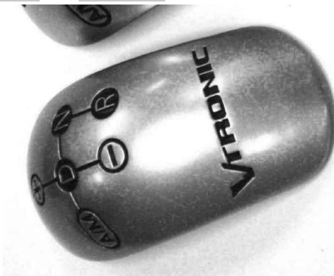
Os veículos equipados com transmissão automatizada não possuem pedal de embreagem. O acionamento da embreagem e as trocas de marchas são realizados por um dispositivo eletro-hidráulico com controle eletrônico.
