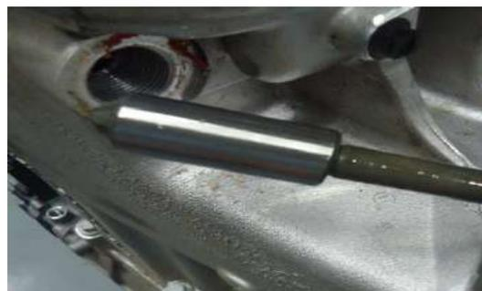
3 – Remover os Parafusos de fixação do GP à carcaça central da caixa de mudanças
