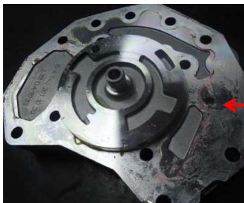
10 – Aplicar massa de vedação na superfície de união da carcaça do GP e a tampa da bomba de óleo/tomada de força
