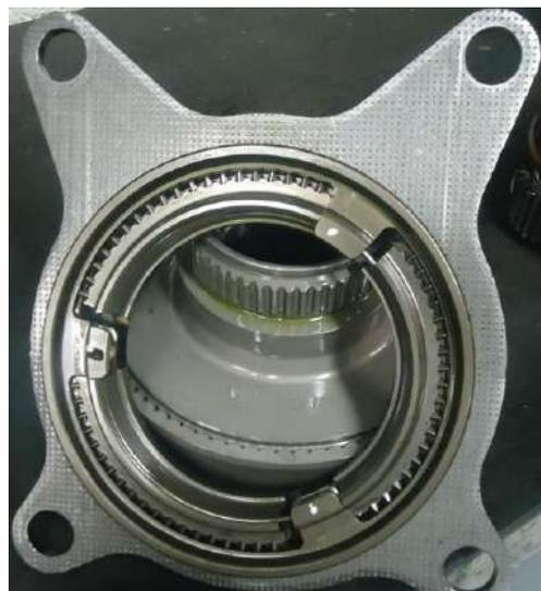
\*Verificar o limite de desgaste dos anéis sincronizadores na montagem (Vide pág.65)
