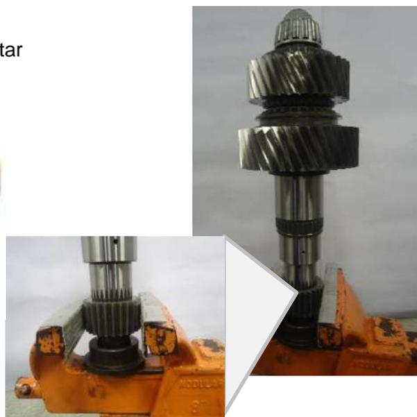
17 – Esquentar a porca dodecagonal (1) com o auxílio de um soprador térmico para facilitar a remoção
