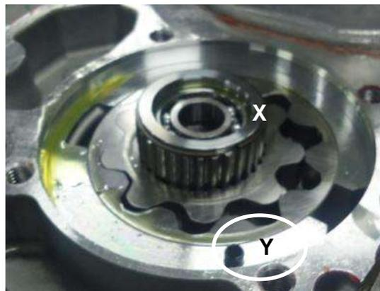
8 – Instalar a(s) válvula(s) de controle de pressão do óleo da caixa de mudanças, conforme aplicação no veículo
