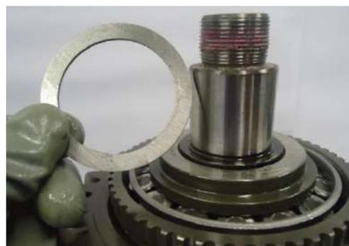
23 - Instalar uma proteção na parte dianteira/ponta da árvore secundária para evitar que a rosca seja danificada na desmontagem do conjunto
