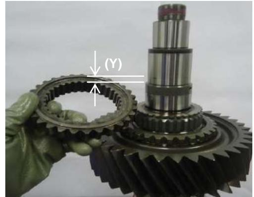
6 – Montar o anel-trava (8) do corpo sincronizador (9)
