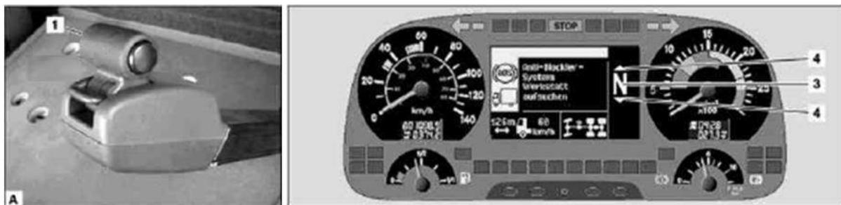
1- Acionar o freio de estacionamento (A luz piloto do freio de estacionamento tem que estar acesa)
