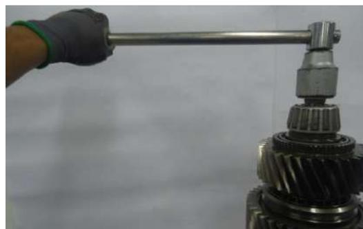
19 – Instalar uma proteção na parte dianteira/ponta da árvore secundária para evitar que a rosca seja danificada na desmontagem do conjunto
