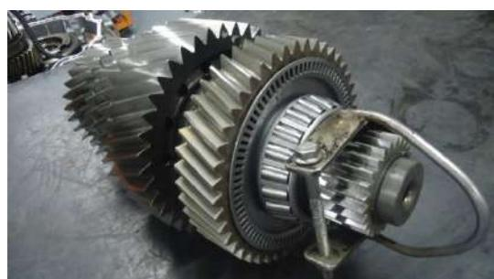
17 – Remover simultaneamente as árvores primária com a luva e corpo de acoplamento do GV e a árvore intermediária como o auxílio de outra pessoa garantindo que o conjunto sincronizador/rolamentos não sejam danificados/forçados
