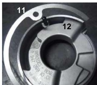
5 – Instalar a carcaça (12) da bomba de óleo com a arruela de compensação (11) na carcaça do GP. Observar a coincidência do pino guia (Y) com o alojamento (Z) na carcaça do GP
