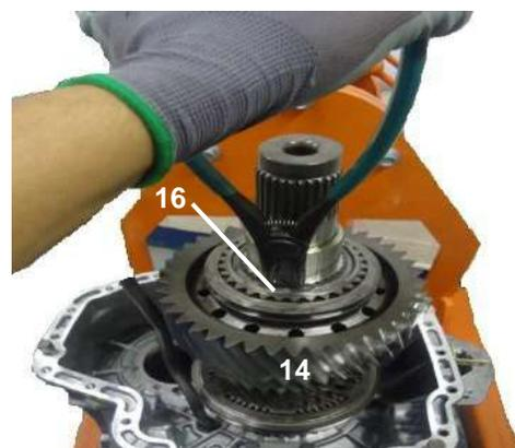
14 – Instalar a engrenagem solar (21) e o anel-trava (22) na árvore secundária (12)
