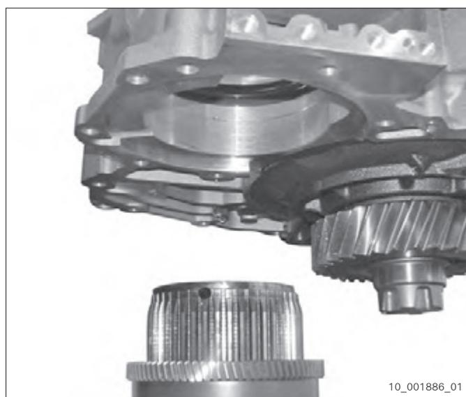
5 Retirar engrenagem de acionamento da bomba de direção e arruela.
